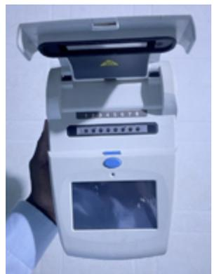
Machine de détection du CSSV, Swissdecode
